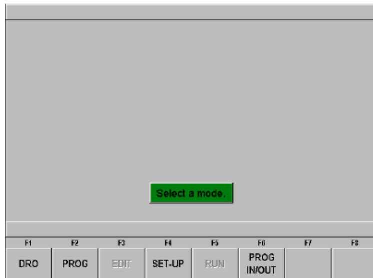
AFBEELDING 4.2.2 Het hoofdscherm Select a mode (selecteer een modus). Hier weergegeven, de modi Run en Edit zijn in het lichtgrijs omdat er geen programma in het geheugen is.
